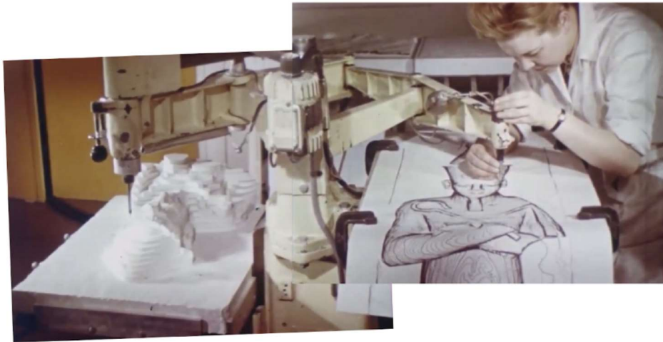
Figure 29: Sur ce montage photo, un homme repasse sur le dessin de l'étape précédente. Parallèlement, un instrument sculpte les profondeurs du relevé sur du polystyrène. 38
