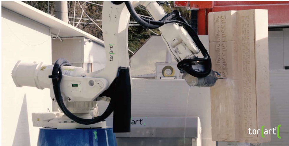
Figure 63: Machine qui taille le matériau avec un jet d'eau sous pression et une fraiseuse. 93
