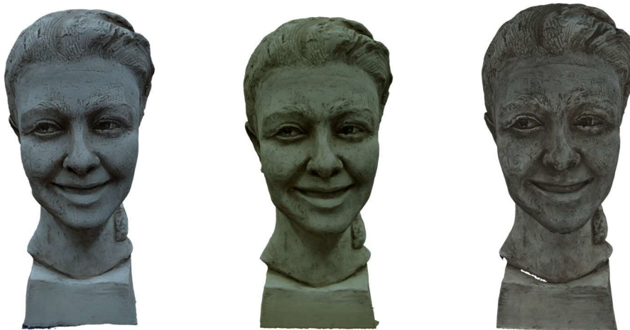
Figure 40: A gauche, scan de la Kinect one, au centre, scan de la Gopro 4K, à droite, scan de la Samsung G5.
